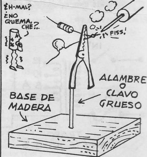
esta idea que aparte de su fácil construcción es muy útil para todos aquellos que sueldan, pintan modelos o realizan cualquier otra tarea por el estilo, se trata de hacer una pata de alambre grueso, en cuya punta se le coloca a presión una pinza cocodrilo de las grandes para sostener lo que querramos pintar o soldar dejándonos nuestras manos libres para realizar la tarea.
