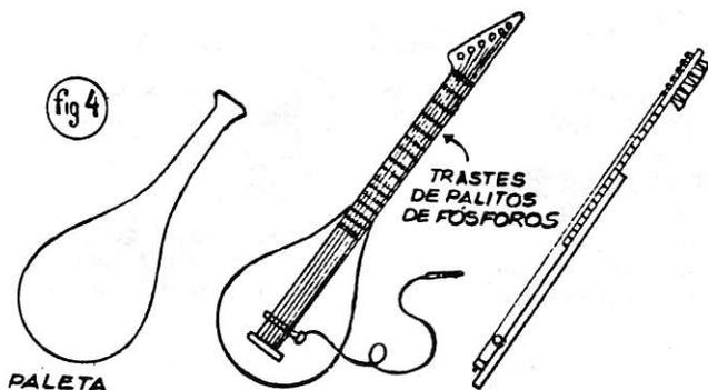
jaremos la madera para que este sólo quede tomado de ese tubito sin apoyar en nada, al cable del audifono le colocaremos una ficha que enchufe en el amplificador, este último puede ser cualquier radio combinado con entrada de pick-up.
